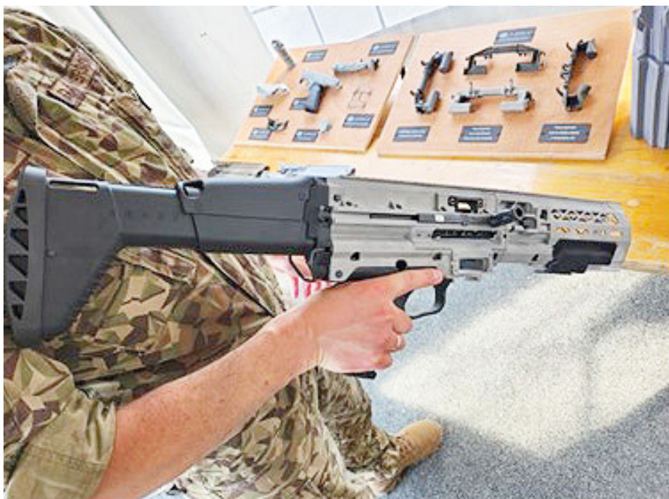
Ar One Click Metal metāla detaļu drukas ierīci drukātas ložmetēja M249 SAW detaļas. Foto: NBS delegācija
